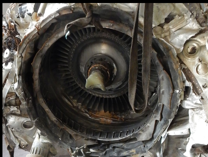
Turbína nese stopy po zadření motoru po dopadu
